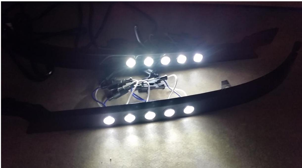
Probelauf an einer noch vorhandenen Batterie. Nach paar Sek. war Schluss. Lampen gingen allein aus. Also zum Bekannten(Boschdienst). Der hat mir dann erklärt, wie es geht. Das Relais wird an + und – der Batterie angeschlossen. Es erkennt selbst, wenn die Batterie geladen wird und dann bleiben die Lämpchen an. Nur noch das übrige Kabel an Standlicht anklemmen,
