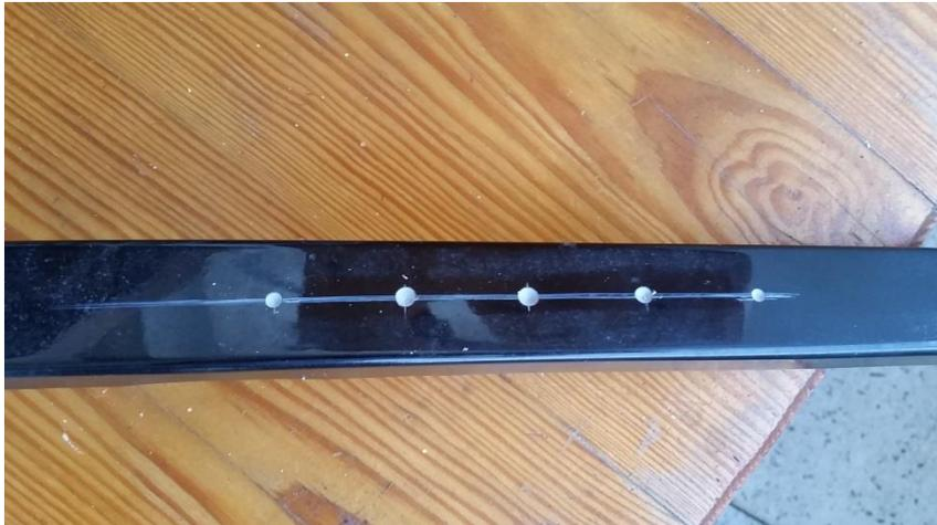
Passt! Also mit weißem Stift grob angezeichnet, dann mit Reißnadel und Stahllineal angerissen und mit Anbohrer die Punkte angebohrt.
