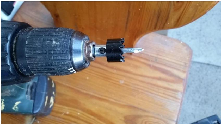
Nun mit der im Lieferumfang inbegriffenen Lochkreissäge die Löcher gebohrt. **VORSICHT!** Niedrige Drehzahl sonst verschmiert die Säge und der Plastekram schmilzt. Danach mit scharfem Messer entgratet, fertig. Die schwarzen Ringe der Lämpchen durchgesteckt (sehr straff) und von hinten verschraubt.
