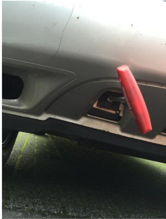
Jetzt die 4 inneren Befestigungen abschrauben, dann kann man die Stoßstange nach vorne rausziehen. Den Temperatursensor Bild 1 nicht vergessen!!!!!!
